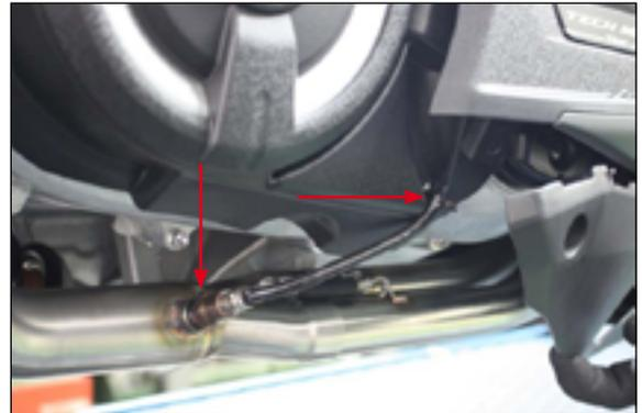
Avvitare la sonda lambda e fissare il cavo mediante fascetta fornita
