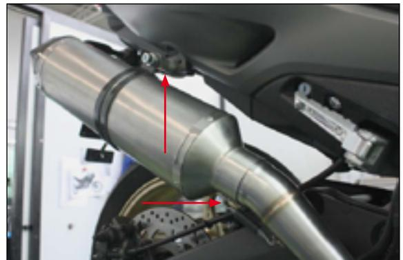
Serrare il terminale mediante fascetta interponendo col telaio lo spessore fornito ed ancorare la molla
