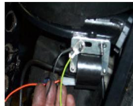
**DIE SPULE ZU SETZEN HAT DEN URSPRUNGSORT, UND MIT DEN SCHEIBEN UND URSPRUNGMUTTERN ZU DRÜCKEN, OHNE ZU VERGESSEN, DAS SCHWARZE KABEL DES DIAGRAMMS UND DAS GRÜN/GELBEN DES STATORS ZU STELLEN HAT DIE MASSE DER SPULE.**
