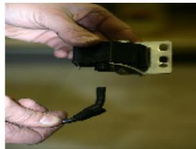
**DAS KABEL AUF DER SPULE ZU SCHRAUBEN HOCHSPANNUNG. UND DEN SCHUTZ ZURÜCKZUKLAPPEN AUF DER SPULE.**
