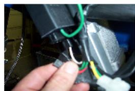
DIE KABEL DER ZÜNDSPULE ENTFERNEN UND DEN WEISSEN 2-WEG-STECKER, DER DEN URSPRÜNGLICHEN STATOR MIT DEM KABELBÜNDEL VERBINDET, AUSSTECKEN
