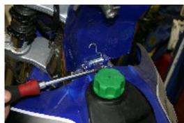
DIE BEFESTIGUNGSSCHRAUBE DER TANKABDEMITTELS EINES KREUZSCHROBENZIEHERS ENTFERNEN,
