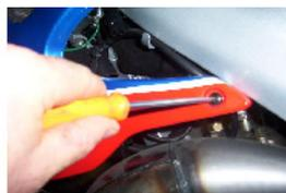
DIE BEIDEN UNTEREN SCHRAUBEN DER RECHTEN UND LINKEN SEITLICHEN VERKLEIDUNGSTEILE DES HEIZKÖRPERS MIT EINEM KREUZSCHROBENZIEHER ENTFERNEN,
