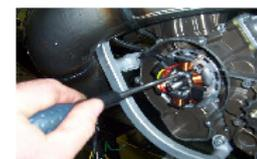
DIE 3 BEFESTIGUNGSSCHRAUBEN DES STATOR MIT EINEM KREUZSCHROBENZIEHER ENTFERNEN
