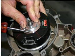
**DEN BLOCK LÖSEN KOLBEN UND DIENEN SIE SIE IN WIE PENSUM IN DREHT DEN DREHBOHRER UM DEN PUNKT ZU FINDEN TOD HOCH. ZUM TOTEN PUNKT HOCH GEMACHT ZUSAMMENFALLEN DIE BEZUGSPUNKTE ROT VOM STATOR UND VON ROTOR UND ROTOR DRÜCKEN MIT DER SCHEIBE UND DER URSPRUNGSMUTTER**
