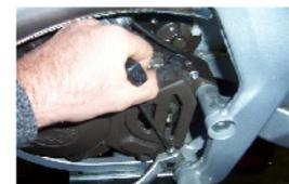
**DIE BEFESTIGUNGSSCHRAUBEN DES FUSSSCHALTHEBELS WIEDER ANBRINGEN**
