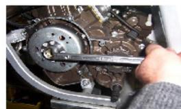
DEN ROTOR GEGEN DIE LAUFRICHTUNG DREHEN, DQMIT DER KOLBEN MIT DEM KOLBENSTOPPER IN KONTAKT KOMMT, DQNN DIE ROTORMUTTER MIT EINEM 0.35ER SCHLÜSSEL AUFDREHEN
