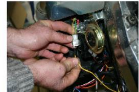
**DAS GELBE KABEL DES PREMIUM STATORS MIT DEM GELBEN KABEL DES 2 WEG-STECKERS DES URSPRÜNGLICHEN KABELBÜNDELS ZUSAMMEN SCHLIESSEN**
