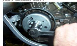
DEN POLRADABZIEHER DERBI EINSETZEN UND DER ROTOR MIT DEN ENTSPRECHENDEN SCHLÜSSELN HERAUSNEHMEN
