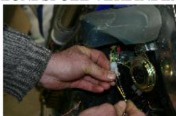
**AM SELBEN STECKER, DAS SCHWARZ/WEISSE KABEL DES CDIS MIT DEM SCHWARZ/GRÜNEN KABEL DES STECKERS VERBINDEN DAS CDI OBERHALB MIT EINEM KABELBINDER BEFESTIGEN, DANN ALLE KABEL MIT 3 KABELBINDERN ZUSAMMEN BINDEN**
