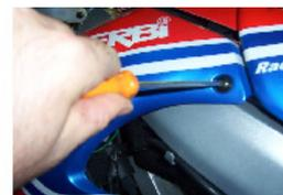
DIE BEIDEN OBEREN SCHRAUBEN DER RECHTEN UND LINKEN SEITLICHEN VERKLEIDUNGSTEILE DES HEIZKÖRPERS MIT EINEM KREUZSCHROBENZIEHER ENTFERNEN.
