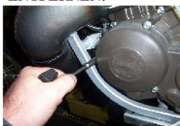
DIE 3 BEFESTIGUNGSSCHROBEN DES ZÜNDUNGSGEHÄUSES MIT EINEM 8ERSCHLÜSSEL ENTFERNEN
