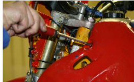
AUSBAU DER RECHTEN SEITLICHEN VERKLEIDUNG
