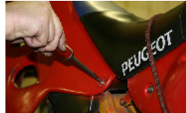
AUSBAU DER RECHTEN SEITLICHEN VERKLEIDUNG
