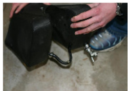
DEN TANK ENTFERNEN ACHTEN SIE DARAUF, DASS DIE PARALLELSCHALTUNG DER BEIDEN TANKSEITEN ABGEDICHTET IST
