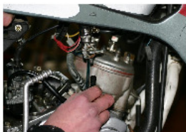
BENZINHAHN ZURDEHN UND BEFESTIGUNGSSCHRAUBEN ENTFERNEN
