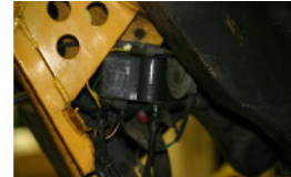
ALLE KABEL VON DER ZÜNDSPULE ENTFERNEN UND HERAUSNEHMEN
