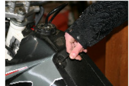
DIE OBEREN BEFESTIGUNGSSCHRAUBEN DER RECHTEN UND LINKEN SEITEN AUF DEM TANK ENTFERNEN
