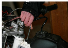
NACHDEM DIE SEITEN ABGENOMMEN SIND, DIE OBEREN BEFESTIGUNGSSCHRAUBEN DES TANKS MIT EINEM 5ER INBUSSCHLÜSSEL ENTFERNEN
