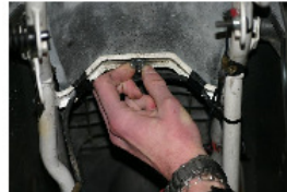
FLÜGELMUTTER UNTER DER SITZBANK ENTFERNEN
