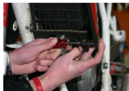
DIE UNTEREN BEFESTIGUNGSSCHRAUBEN DER RECHTEN UND LINKER SEITEN UM DEN HEIZKÖRPER FERNER ENTFERNEN
