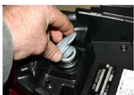
RETIRER LE BOUCHON DU RÉSERVOIR D'HUILE.
