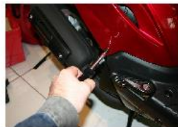
RETIRER LA VIS AVANT DROITE DU CACHE DESSOUS DE SELLE.
