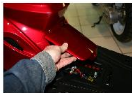
DÉPOSER LE CACHE BATTERIE AVEC UN TOURNEVIS CRUCIFORME.
