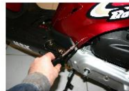
RETIRER LA VIS AVANT GAUCHE DU CACHE DESSOUS DE SELLE.
