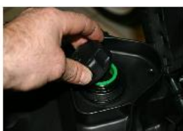
RETIRER LE BOUCHON DU RÉSERVOIR D'ESSENCE.
