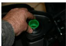
RETIRER LE JOINT D'ÉTANCHEITÉ EN CAOUTCHOUC ENTRE LE RÉSERVOIR ET LE COFFRE.
