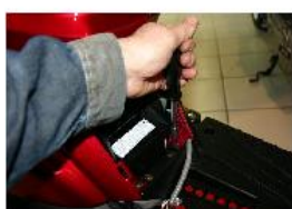
RETIRER LES 2 VIS AVANT DU CACHE DESSOUS DE SELLE AVEC UN TOURNEVIS CRUCIFORME..
