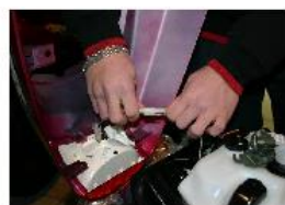
RETIRER LE CONNECTEUR D'ÉCLAIRAGE ARRIÈRE PUIS DÉPOSER LE CACHE DESSOUS DE SELLE.
