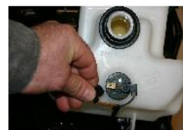
RETIRER LES 2 CABLES DE LA SONDÉ DE NIVEAU SUR LE VASE D'EXPANSION.
