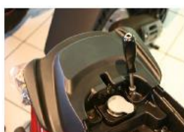
RETIRER LES 2 VIS ARRIÈRES DU SPOILER AVEC UNE CLÉ A PIPE DE 10.
