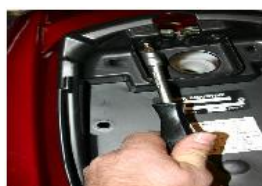
DÉPOSER LE VEROUILLAGE DE SELLE FIXÉ AVEC 2 VIS AVEC UN TOURNEVIS CRUCIFORME..
