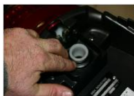
RETIRER LE JOINT D'ÉTANCHEITÉ EN CAOUTCHOUC ENTRE LE RÉSERVOIR D'HUILE ET LE COFFRE ET RETIRER LE COFFRE EN TIRANT DOUCEMENT SUR LA SELLE.
