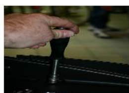
RETIRER LES 2 VIS AVANTS DU SPOILER AVEC UNE CLÉ A PIPE DE 10.
