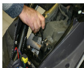
DIE BEFESTIGUNGSSCHRAUBEN ÜBEN TOPF AM ZYLINDER MITTELS EINER BOHRRATSCHKE UND HÜLSE VON 10 ZU LÖSEN UND ABZULEGEN.
