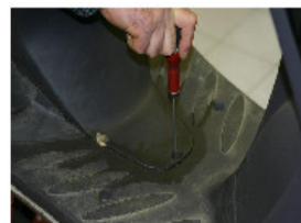
DIE HÖHERE SCHRAUBE DER CACCHE BATTERIE MITTELS EINES SCHLÜSSELS TORX VON 20 ODER EINES FLACHEN SCHRAUBENZIEHERS ZURÜCKZUZIEHEN.
