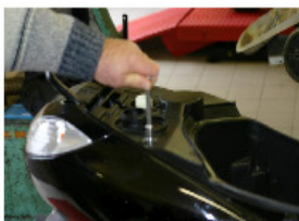
NUR AUF TREKKERS UND SPEEDFICHT DIE SCHRAUBEN DER HÖHERSTEN VOM KOFFER MITTELS DES SCHLÜSSELS HAT ZURÜCKZUZIEHEN PFEIFE VON 10 MM
