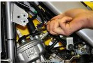
**REASSEMBLE THE SPARK PLUG WITH ITS CONNECTOR CAP.**
