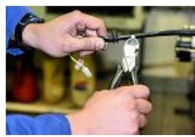
**CUT THE COLLAR ON THE TUBE. RECOVER THE SHUTTER ON THE TUBE OF THE ORIGINAL IGNITION.**
