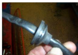
RECOVER The MASTER KEY WIRE ON The SHEATH OF The STATOR OF ORIGIN TO PLACE IT ON The SHEATH OF The MILLÉNIUM. TUBULAR HEXAGON BOX SPANNER TUBE OF 16.
