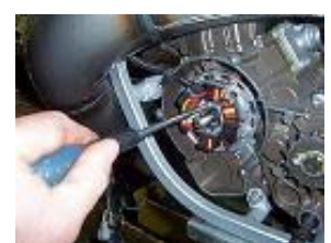
RETIRER LES 3 VIS DE FIXATION DU STATOR AVEC UN TOURNEVIS CRUCIFORME.
