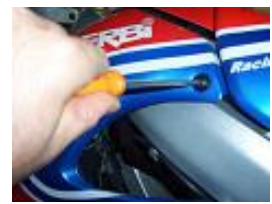
RETIRER LES 2 VIS SUPERIEURES DES FLANS DE RADIATEUR DROIT ET GAUCHE AVEC UN TOURNEVIS
