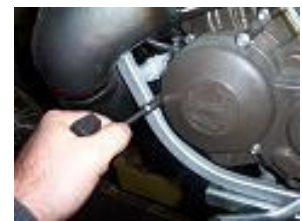
RETIRER LES 3 VIS DE FIXATION DU CARTER D'ALLUMAGE AVEC UNE CLE A PIPE DE 8.
