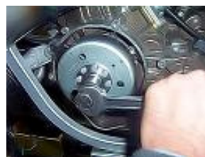
POSITIONNER L'EXTRACTEUR DERBI ET EXTRAIRE LE ROTOR A L'AIDE DES CLES
