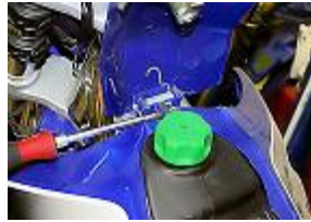
RETIRER LA VIS SUPPORT DU CACHE RESERVOIR AVEC UN TOURNEVIS CRUCIFORME
