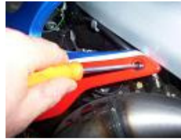
RETIRER LES 2 VIS INFERIEURES DES FLANS DE RADIATEUR DROIT ET GAUCHE AVEC UN TOURNEVIS
