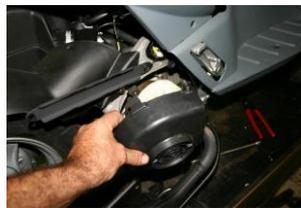
**Remonter lae cache ventilette ou de la pompe a eau avec les vis d'origine**
