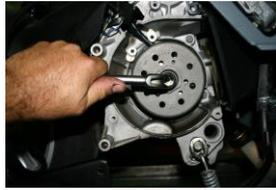
**Placer la rainure A sur la clavette du vilebrequin et serrer le rotor avec l'ecrou d'origine**
