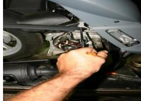
**Retirer la seconde vis de fixation du renfort de pot**
