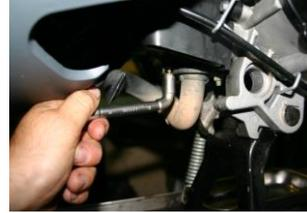
**Retirer les 2 ecrous de fixation d'echappement du cylindre avec une cle de 10**
