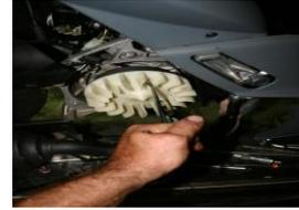
**Remonter la turbine avec les 3 vis btr 5x16 fournies. Pour les modeles liquiderepositionner les 3 doigts d'entrainement de la pompe a eau sur le rotor avec les rondelles et les vis d'origine.**
