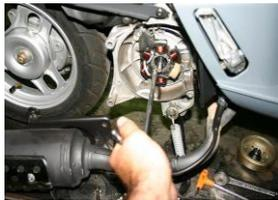
**Deposer les 2 vis de fixation du stator**
