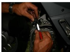
**Couper sur l'arriere le passe fil d'origine et le recuperer. Deposer le stator d'origine et son cablage**
