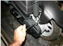
**Deposer la vis du garde boue arriere cote gauche**
