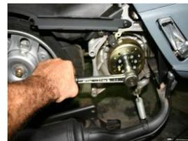
**Tourner le rotor a la main dans le sens opposé a la rotation pour que le piston vienne en contact avec le bloque piston et desserrer l'ecrou d'allumage avec**
