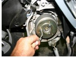
**Positionner la platine support de turbine ou support de pompe a eau sur le rotor**
