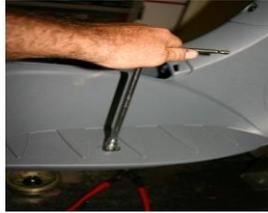
**Depose des 2 vis de tablier avec une cle a pipe de 10 etdegrafe le tablier inferieur en poussant**
