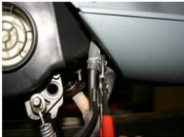
**Retirer le collier et le tube du catalyseur**
