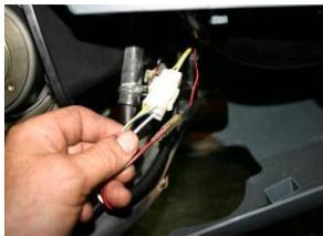
**Brancher dans le connecteur blanc d'origine le fil jaune du stator MVT avec le fil jaune du faisceau. Le fil blanc du stator MVT avec le fil blanc du faisceau d'origine**
