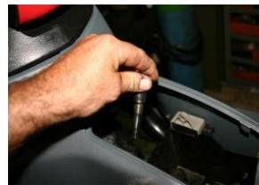
**Retirer le bloque piston et replacer la bougie avec son antiparasite**
