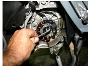
**Passer le faisceau du stator Millenium par le meme endroit que celui d'origine et fixer le stator avec les 2 vis btr de 6x30fournies.**
