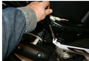
REMOVE THE BACK SCREW OF THE FEET SUPPORT.
