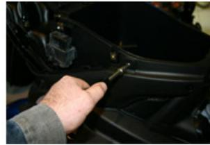
REMOVE THE 2 SCREWS OF THE BACK PLASTIC PROTECTION UNDER THE SADDLE.
