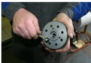
PALCE BACK The 3 PUMP FINGERS ON MILLENIUM ROTOR WITH SAME KEY OF 10mm.
