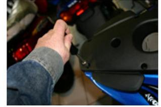
REMOVE THE SECOND BACK SCREW OF THE RIGHT BACK PLASTIC PROTECTION.
