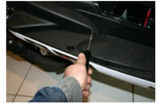
REMOVE THE 2 SCREWS OF THE LOWER PLASTIC PROTECTION UNDER THE SADDLE.
