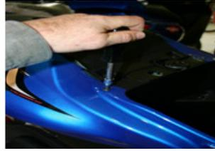
REMOVE THE CENTRAL SCREW OF THE RIGHT BACK PLASTIC PROTECTION.
