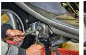
Desserrer l'écrou de 14 qui serre le rotor et venir visser l'extracteur Peugeot pour déposer le rotor à l'aide des clés correspondantes.
