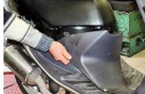
Pour retirer le cache, baisser la selle et d'éclipser les cotes en faisant basculer vers l'avent.
