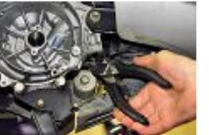
Dépose du collier plastique maintiennent Le câble de sortie de l'allumage et ouvrir l'agrafe ou dessus du démarreur pour retirer le faisceau.
