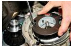
Récupérer le passe câble d'origine et le placer sur la gaine du premium passer la gaine par le trou et fixer le stator au carter avec les 2 vis 5x30mm.
