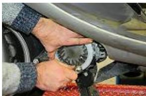
Toujours a l'aide d'une clé à pipe de 8 mm ou a l'aide d'une clé à cliquet avec rallonge et douille de 8 mm desserrer et retirer les vis de fixation du ventilateur.
