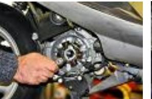
Démonter le stator à l'aide d'un cliquet et sa douille de 8 ou d'une clé à pipe.
