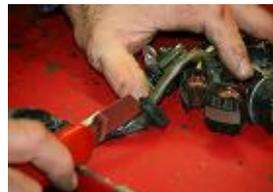
**RECUPERER LE PASSE FIL DU STATOR D'ORIGINE EN LE COUPANT EN ARRIERE ET PLACER LE SUR LA GAINÉ DE L'ALLUMAGE PREMIUM POUR OBTURER LE CARTER D'ORIGINE**
