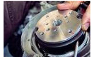
Positionner une pige de calage dans le trou de la bougie pour caler le vilebrequin a 0.35mm avant le point mort haut et placer le rotor sur le vilebrequin en faisant coïncider les 2 repères rouges du stator et du rotor.
