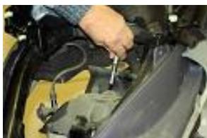
Placer un bloque piston a la place de la bougie et appuyer doucement sur le kick pour faire tourner le vilebrequin afin que le piston vienne en contact avec le bloque piston.
