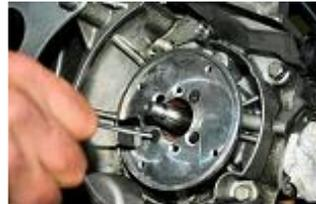
Montage de la platine à l'aide de 2 vis 6x16 têtes fraisées fournies.
