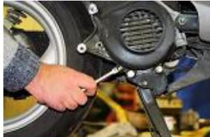
A l'aide d'une clé à pipe de 8 mm ou a l'aide d'une clé à cliquet avec rallonge et douille de 8 mm.
