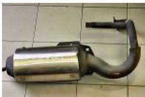
Dépose du pot d'échappement
