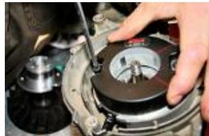
**RECUPERER LE PASSE FIL SUR LE STATOR D'ORIGINE ET LE PLACER SUR LA GAINÉ DE L'ALLUMAGE**
