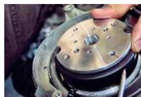
**POSITIONNER UNE PIGE DANS LE TROU DE BOUGIE ET TOURNER LE VILEBREQUIN A 0.35MM ET POSITIONNER LE MOTEUR PREMIUM, PUIS PASSER OU POINT MORT HAUT ET**
