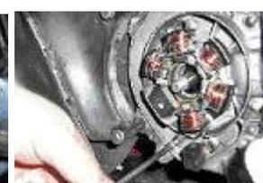
**DEPOSER LES DEUX VIS DU CAPTEUR AVEC UN TOURNEVIS CRUCIFORME.**
