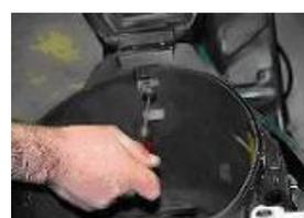
**RETIRER LA VIS INTERIEURE DU COFFRE AVEC UN TOURNEVIS CRUCIFORME.**
