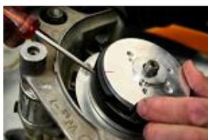
Placer le rotor sur le vilebrequin en positionnant les repères rouge du stator et du rotor l'un en face de l'autre.
