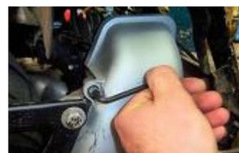
**Repositionner les vis support du cache allumage avec une clé Allen de 5.**
