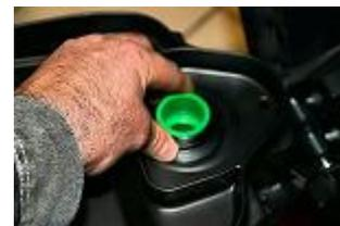
Retirer le joint d'étanchéité en caoutchouc entre le réservoir et le coffre.
