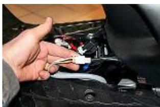
**Débrancher le connecteur reliant le stator au faisceau qui se trouve au dessus de la batterie et couper les colliers plastiques retenant la gaine du stator le long du châssis jusqu'au carter moteur.**
