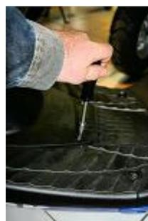
**Retirer les vis de fixation du cache dessous de selle avant avec un tournevis cruciforme.**
