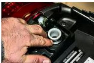
**Retirer le joint d'étanchéité en caoutchouc entre le réservoir d'huile et le coffre et retirer le coffre en tirant doucement sur la selle.**
