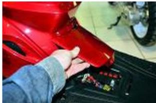
Déposer le cache batterie avec un tournevis cruciforme.
