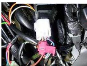
**Présenter le clip rouge fourni sur le câble marron du cdi d'origine et placer le câble marron du diagramme dans le deuxième emplacement du clip et le fermer avec une pince pour mettre en contact les 2 câbles marron.**
