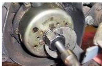
**Positionner l'extracteur MBK et Yamaha. Extraire le rotor a l'aide des clés correspondantes.**
