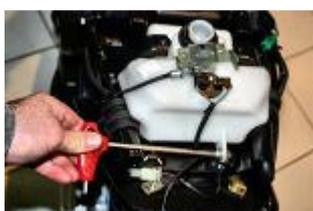
**Retirer la vis support du vase d'expansion avec une clé Allen de 5.**
