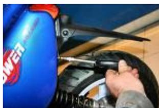
**Retirer la vis de fixation centrale du cache gauche du dessous de selle.**
