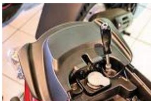
Retirer les 2 vis arrière du spoiler avec une clé à pipe de 10.
