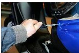
**Retirer la vis de fixation avant du cache du dessous de selle.**
