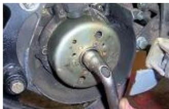
**Tourner le rotor dans le sens inverse du sens de la rotation pour que le piston vienne en contact avec le bloc piston. Desserrer l'écrou du rotor avec une clé a pipe de 16.**
