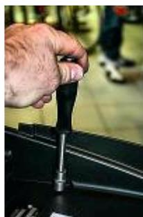
Retirer les 2 vis avant du spoiler avec une clé à pipe de 10.
