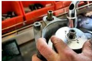
Fixer le bloc piston en le resserrant doucement et serrer le rotor avec l'écrou d'origine puis une fois le rotor serré re-contrôler que les repères rouges coïncides au point mort haut.
