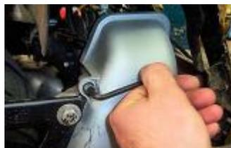
**Retirer les vis support du cache allumage avec une clé Allen de 5 et le retirer.**
