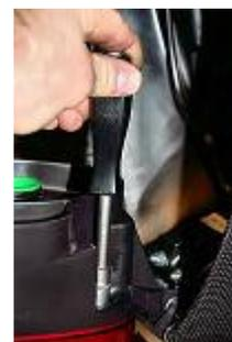
Retirer les 2 vis droites et gauches du coffre avec une clé à pipe de 10.
