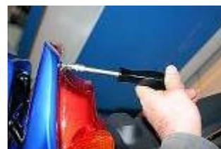
**Retirer la vis de fixation arrière du cache gauche du dessous de selle.**
