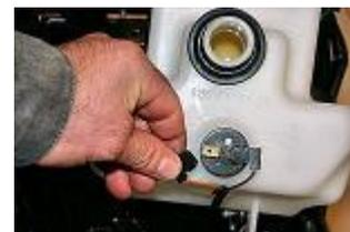
**Retirer les 2 câbles de la sonde de niveau sur le vase d'expansion.**
