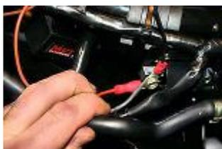
**Brancher le câble orange du diagramme sur la bobine haute tension et après avoir dévisé une des vis de fixation de la bobine, revissez la avec le câble noir de masse du diagramme.**
