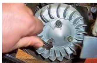
**Repositionner les 3 vis d'origine support de ventilateur avec une clé Allen de 5.**
