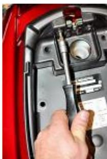
Déposer le verrouillage de selle fixé avec 2 vis à l'aide d'un tournevis cruciforme
