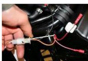
Après avoir placé la gaine du stator premium le long du châssis comme d'origine et l'avoir fixé avec des colliers plastiques, brancher le connecteur 4 voies du stator avec celui du faisceau.
