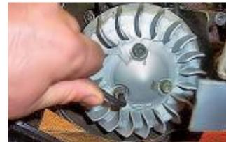
Resserrer le ventilateur ou les pions d'entraînement de pompe a eau pour les modèles liquides avec les vis d'origine.
