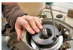
Passer les câbles du stator par le trou d'origine du carter et serrer le stator sur la platine avec les 2 vis Allen 5x30 mm fournies.
