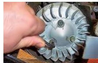
**Retirer les 3 vis support de ventilateur avec une clé Allen de 5.**
