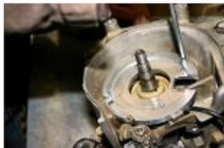
Positionner la platine en gardant le joint papier d'origine et la serrer avec les 2 vis Allen De 6 mm d'origine.
