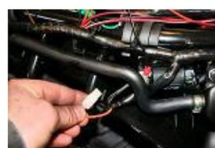
Retirer le câble orange de la bobine haute tension d'origine.
