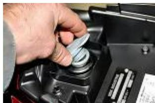
Retirer le bouchon du réservoir d'huile.
