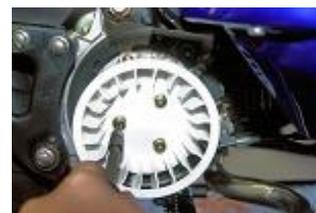
Remonter le ventilateur avec ses 3 vis cruciformes.
