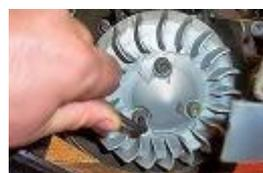
Resserrer le ventilateur ou les pions d'entraînement de pompe à eau pour les modèles liquides avec les vis d'origine.
