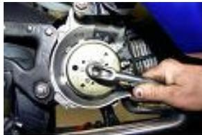
Desserrer l'écrou du rotor à l'aide d'une clé à pipe de 17.
