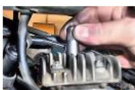
Dévisser le bloc piston et remplacer le par une pige de calage et positionner le piston à 0.35 mm avant point mort haut.
