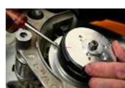
Placer le rotor sur le vilebrequin en positionnant les repères rouges du stator et du rotor l'un en face de l'autre.
