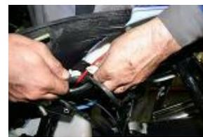
Débrancher les câbles individuels et le connecteur du stator.
