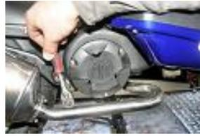
Retirer les vis avec une clé de 8 et la vis cruciforme situé à coté de la vis supérieure pour enlever le cache allumage.
