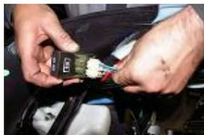
Déposer le CDI d'origine et débrancher les 2 connecteurs.
