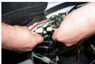
Brancher le connecteur 3 voies du stator MVT avec le connecteur 3 voies du faisceau et le câble noir du stator sur le câble noir du diagramme MVT. Brancher les câbles rouge / noir du stator avec les câbles rouge / noir du diagramme MVT.
