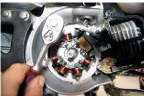
Déposer le stator avec une clé à pipe de 8 et retirer le faisceau.
