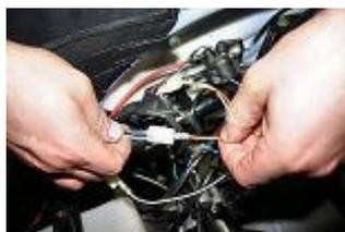
Brancher le câble orange du diagramme MVT sur le câble blanc/noir du connecteur 4 voies anciennement branchée sur le CDI d'origine.
