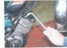
Retirer la bougie avec une clé de 21.
