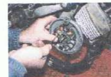
Positionner le stator MVT avec les 2 vis fournies 5x20, en contrôlant que les câbles arrière du stator ne soit pas pincer par la platine.
