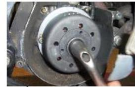
PRÉSENTER L'ÉCROU D'ORIGINE ET SERRER AVEC UNE CLÉ A PIPE DE 16.
