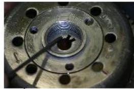
PRÉSENTER LE ROTOR SUR LE VILBREQUIN EN PLACANT LA RAINURE "A" SUR LA CLAVETTE DU VILBREQUIN
