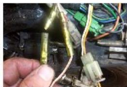
DÉCONNECTER LES CABLES ROUGE/NOIR ET BLANC/ROUGE RELIANT LE CDI AU STATOR ET RETIRER LE CONNECTEUR 3 VOIES AVEC LES CABLES BLANC ET ROUGE/JAUNE ET SORTIR LE CABLAGE DU CHASSIS.
