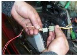
REPASSER LA GAINÉ DU STATOR MILLÉNIUM LE LONG DU CHASSIS COMME D'ORIGINE ET CLIPSER LES CONNECTEURS 3 VOIES DU STATOR ET DU FAISCEAU, CABLE JAUNE/ROUGE ENSEMBLE ET BLANC ENSEMBLE.
