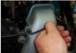
RETIRER LES VIS SUPPORT DU CACHE ALLUMAGE AVEC UNE CLÉ ALLEN DE 5 ET LE RETIRER.
