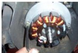
PASSER LA GAINÉ DE L'ALLUMAGE MILLÉNIUM PAR LE TROU DU CARTER D'ORIGINE ET POSITIONNER LA PLATINE EN PRÉSENTANT UNE VIS DE FIXATION D'ORIGINE SUR LE TROU REPERE "H" DE LA PLATINE, PRÉSENTER LA SECONDE VIS ET SERRER L'ENSEMBLE AVEC UNE CLÉ ALLEN DE 5.
