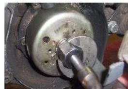
DESSERRER L'ÉCROU DU ROTOR AVEC UNE CLÉ A PIPE ET POSITIONNER L'EXTRACTEUR MBK ET YAMAHA, EXTRAIRE LE ROTOR A L'AIDE DES CLÉS CORRESPONDANTES.
