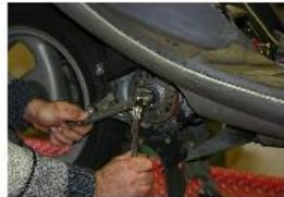
DESSERRER L'ÉCROU DE 14 QUI SERRE LE ROTOR ET VENIR VISSER L'EXTRACTEUR PEUGEOT POUR DÉPOSER LE ROTOR A L'AIDE DES CLÉS CORRESPONDANTES.
