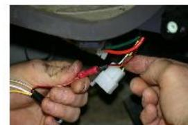
REPASSER LE FAISCEAU DU STATOR MILLENUM PAR LES MEMES AGRAFES ET BRANCHER LES CABLES ROUGE/NOIR ENSEMBLES.
