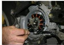
APRÈS AVOIR REPLACÉ LES 2 COLLIERES PLASTIQUES, PRÉSENTER LE STATOR SUR LE CARTER ET LE FIXER A L'AIDE DES 2 VIS BTR DE 6 mm TETE BOMBÉE FOURNIES ET SERRER A L'AIDE D'UNE CLÉ ALLEN DE 4 mm.
