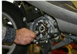
DÉMONTER LE STATOR A L'AIDE D'UN CLIQUET ET SA DOUILLE DE 8 OU D'UNE CLÉ A PIPE.
