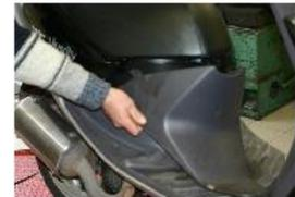
POUR RETIRER LE CACHE, BASSER LA SELLE ET DÉCLIPSER LES CÔTÉS EN FAISANT BASCULER VERS L'AVANT.
