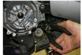
DÉPOSE DU COLLIER PLASTIQUE MAINTENANT LE CABLE DE SORTIE DE L'ALLUMAGE ET OUVRIR L'AGRAFE AU DESSUS DU DÉMARREUR POUR RETIRER LE FAISCEAU.
