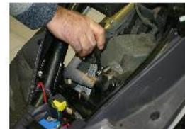
DÉSSERRER ET DÉPOSER LES VIS DE FIXATION POT AU CYLINDRE À L'AIDE D'UN CLIQUET ET DOUILLE DE 10.
