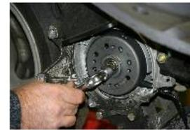
SERRER LE ROTOR A L'AIDE DE L'ÉCROU D'ORIGINE ET D'UNE CLÉ A PIPE DE 14.
