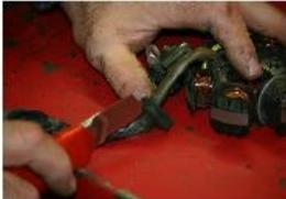
RÉCUPERER LE PASSE FIL DU STATOR D'ORIGINE EN LE COUPANT A L'ARRIÈRE .
