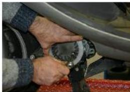
TOUJOURS A L'AIDE D'UNE CLÉ A PIPE DE 8 mm OU A L'AIDE D'UNE CLÉ A CLIQUET AVEC RALLONGE ET DOUILLE DE 8mm DESSERRER ET RETIRER LES VIS DE FIXATION DU VENTILATEUR.
