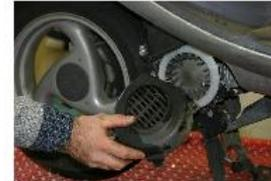
REMONTER LE CACHE ALLUMAGE AVEC SES VIS DE 5 mm D'ORIGINE A L'AIDE D'UNE CLÉ A CLIQUET ET DOUILLE DE 8 mm.
