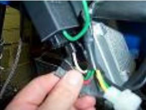
**RETIRER LE CABLE DE LA BOBINE HAUTE TENSION ET DECONNECTER LE CONNECTEUR 2 VOIES BLANC RELIANT LE STATOR D'ORIGINE AU**
