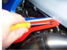
**RETIRER LES 2 VIS INFERIEURES DES FLANS DE RADIATEUR DROIT ET GAUCHE AVEC UN TOURNEVIS**
