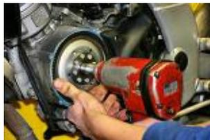
**DESSERRER L'ECROU DE 15 DU ROTOR A L'AIDE D'UN PISTOLET A AIR COMPRIE.**
