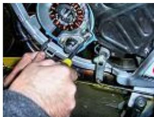
**RETIRER LES 2 VIS DE CAPTEUR A L'AIDE D'UN TOURNEVIS CRUCIFORME.**
