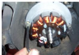
Infilare la guaina dell'accensione MILENNIUM nel buco del carter originale e posizionare la piastrina infilando una vite di fissaggio originale sul buco segnalato "V" della piastrina, mettere in posizione la seconda vite e stringere l'insieme con una chiave allen da 5.
