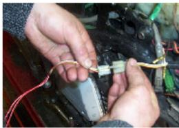
Ripassare la guaina dello statore MILLENIUM lungo il telaio come era prima e collegare i connettori 3 vie dello statore e del fascio, cavo giallo/rosso insieme e bianco insieme.
