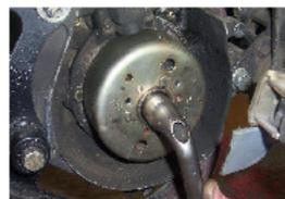
Girare il rotore in senso contrario del senso di rotazione affinché il pistone sia in contatto con la candela blocca pistone, allentare il dado del rotore con una chiave a tubo da 16.
