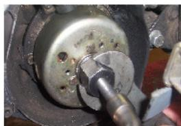
Posizionare l'estrattore MBK e YAMAHA. Attenzione, l'estrattore si avvita alla rovescia, poi estrarre il rotore con l'aiuto delle chiavi corrispondenti.
