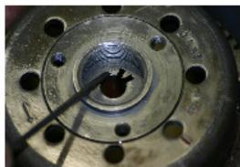
Posizionare il rotore sull'albero motore mettendo la scanalatura "A" sul perno a mezzaluna dell'albero motore.
