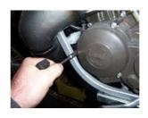
REASSEMBLE THE 3 FIXATION SCREWS OF THE IGNITION CARTER WITH A KEY OF 8.
