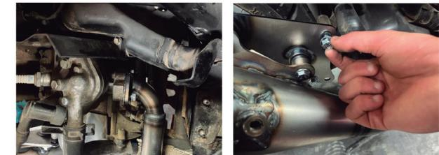
4- Sujetar el tubo de escape con una mano mientras se aprietan las tuercas de m6 del colector luego apretar las tuercas del escape al soporte por último apretar los tornillos del soporte al chasis.
