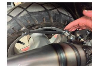
5- Colocar boquilla de entrada al silenciador con la posición de la hendidura para el muelle en el mismo sentido que la boca de salida del silenciador y apretar las 2 tuercas M6 en los espárragos. Poner juntas tóricas en los canales de la boquilla.
