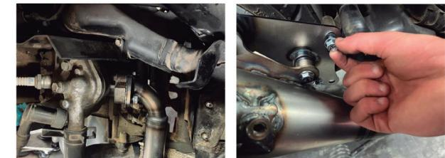
4- Tenez le tuyau d'échappement d'une main tout en serrant les écrous M6 sur le collecteur, puis serrez les écrous d'échappement au support, et enfin serrez les boulons du support au châssis.
