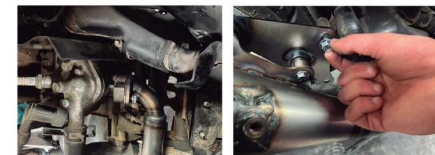
4- Halten Sie das Abgasrohr mit einer Hand, während Sie die M6-Muttern am Krümmer festziehen, ziehen Sie dann die Auspuffmuttern an der Stütze fest und ziehen Sie schließlich die Schrauben der Stütze am Rahmen fest.
