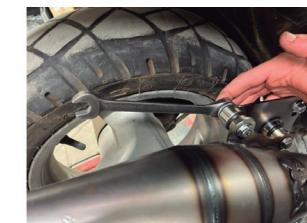
5- Placez la buse d'entrée sur le silencieux avec la position de la fente pour le ressort dans le même sens que l'embouchure de sortie du silencieux et serrez les 2 écrous M6 sur les goujons. Mettez des joints toriques dans les canaux des buses.
